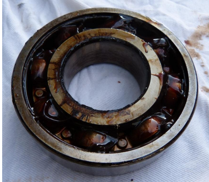
Abbildung 12: Ausgebautes, mit Fremddöl kontaminiertes, Lager
